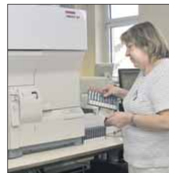
Blutbildautomat: Christine Illenberger beim Bestücken des Automaten zur Analyse der Blutzellen und des Blutfarbstoffes.
